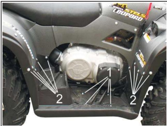
1. Винты крепления опоры для ног к металлическому корпусу.
