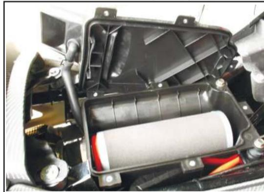
Вставьте новый фильтрующий элемент воздушного фильтра на свое место и установите снятые детали.
