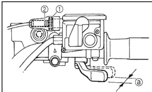
1. Контргайка 2. Регулировочный винт.
