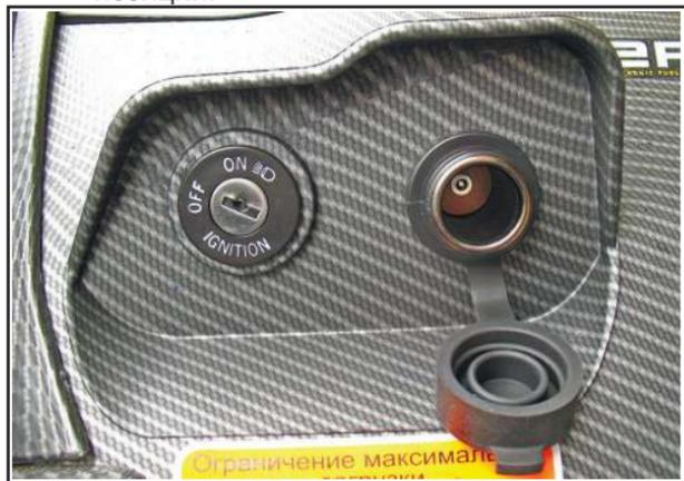
« **OFF** » - двигатель и освещение не работает, все электроприборы выключены. Ключ можно вынуть. Для выключения двигателя установите ключ в это положение.
