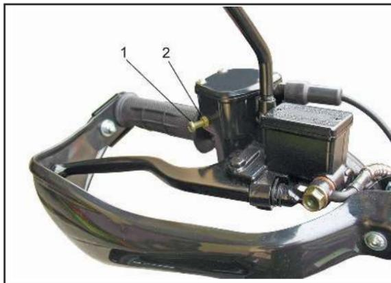
1. Регулировочный винт. 2. Контргайка
