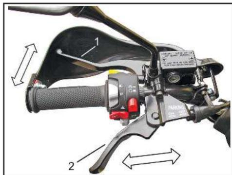
Левый рычаг тормоза (1) - торможение задних колес.
