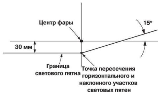
2. Установите снегоболотоход на ровной, горизонтальной поверхности так, чтобы расстояние от фары до экрана было 3м, и продольная ось снегоболотохода была перпендикулярна экрану.
