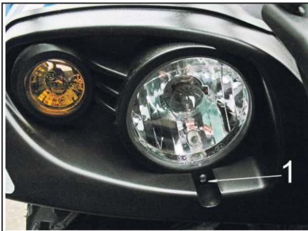
Поверните регулировочный винт (1) по часовой стрелке - чтобы поднять световой пучок фары. Поверните регулировочный винт (1) против часовой стрелки - чтобы опустить световой пучок фары.
