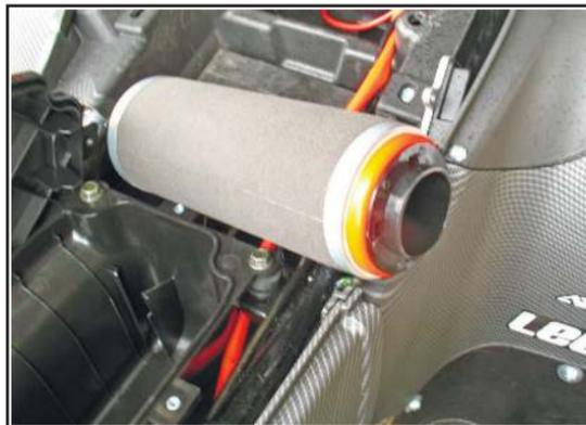
Извлеките использованный фильтрующий элемент.
