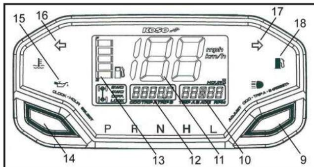
10. Одометр. Отображает пробег в **км** или **милях**, в зависимости от выбранных единиц измерения.
