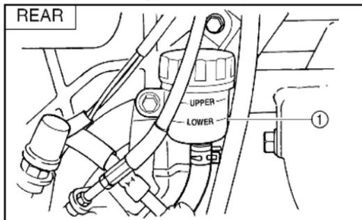
Пониженный уровень тормозной жидкости может свидетельствовать о износе тормозных колодок или утечке тормозной жидкости. Если уровень тормозной жидкости понижен, обязательно проверьте тормозную систему на отсутствие протечек, а так же проверьте степень износа тормозных колодок.
