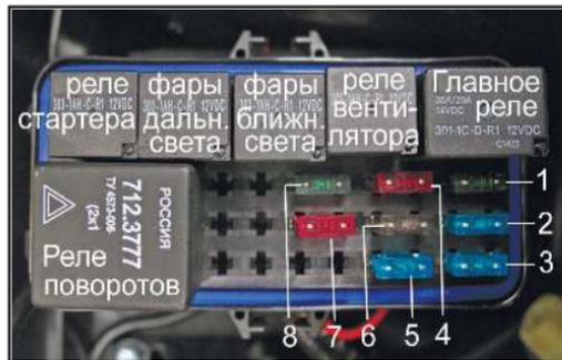
Блок реле и предохранителей (инжектор):
