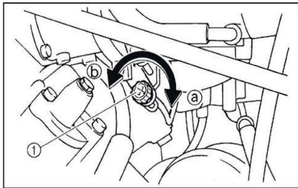
1. Регулировочный винт карбюратора.
