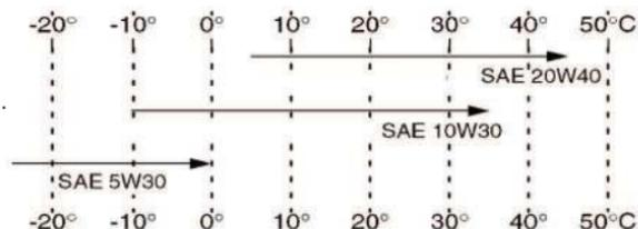
Рекомендованные спецификации моторного масла.....API Service SE, SF, SG
