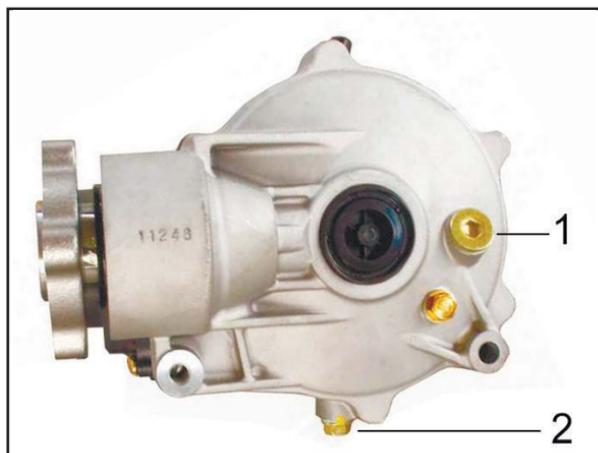
1. Болт масляного привального отверстия.
