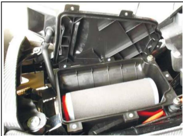
7. Вставьте фильтрующий элемент в корпус воздушного фильтра и закрепите на своем месте крышку.
