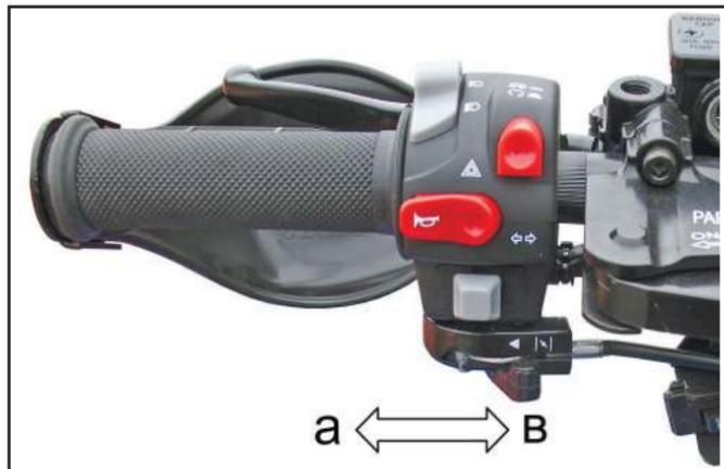
Поверните рычаг управления воздушной заслонкой в положение:
