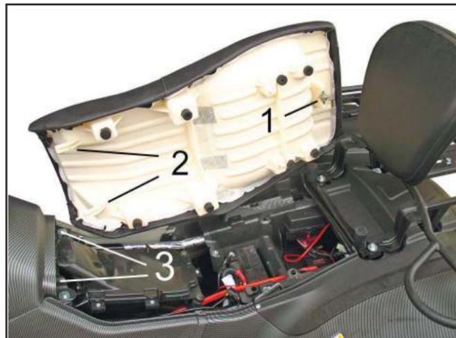
Оно состоит из аварийного выключателя (1), соединенного посредством витого шнура с браслетом (3), который крепится к руке водителя.
