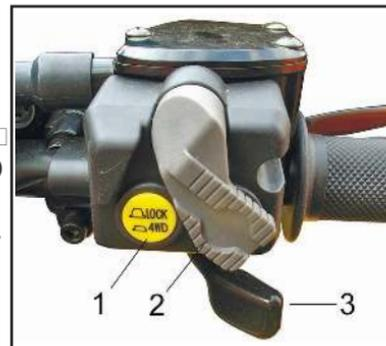
Перед включением блокировки дифференциала, (см.стр.71) убедитесь, что включен режим полного привода. Остановите снегоболотоход. Переведите флажок-предохранитель вправо и отожмите кнопку (1) в положение «**LOCK**». Когда дифференциал заблокирован, на приборной панели загорится индикатор блокировки дифференциала «**DIFF. LOCK**»
