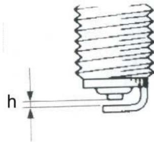
h - Зазор между электродами свечи зажигания.
