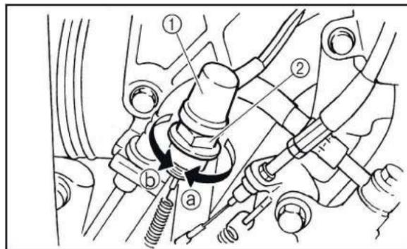
1. Концевой переключатель. 2. Регулировочная гайка.
