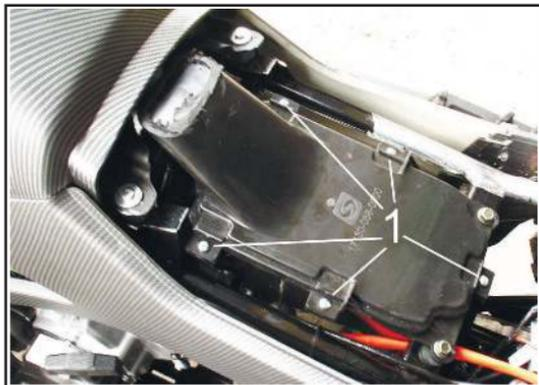
Отвинтите винты (1) крышки воздушного фильтра и снимите крышку воздушного фильтра.
